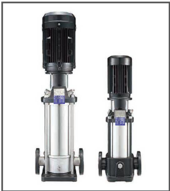
MSTV 系列為非自吸式立式多段離心泵。泵浦進出口在同一水平線上，不占空間，安裝簡便。泵浦配置全密閉型、IEC 標準馬達，F 級絕緣，防護等級有 IP55、IP54 及 IP44。全系列配有卡匣式機械軸封，方便維護，延長作業壽命。
